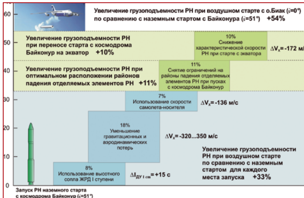
Сравнение грузоподъемности ракет-носителей наземного и воздушного стартов при выведении на низкую околоземную орбиту высотой 200 км
